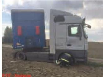
zeug bei einem versuchten Wendemanöver auf unbefestigten Untergrund eingesunken. Die Zugmaschine konnte, nachdem sie vom Auflieger getrennt worden war, aus dem Acker auf den Güterweg gezogen werden. Auch der Auflieger wurde wieder gerade in Fahrtrichtung positioniert. Das Fahrzeuggespann wurde anschließend mittels Seilwinde auf befestigten Untergrund gezogen und der Fahrer konnte seine Fahrt fortsetzen.
